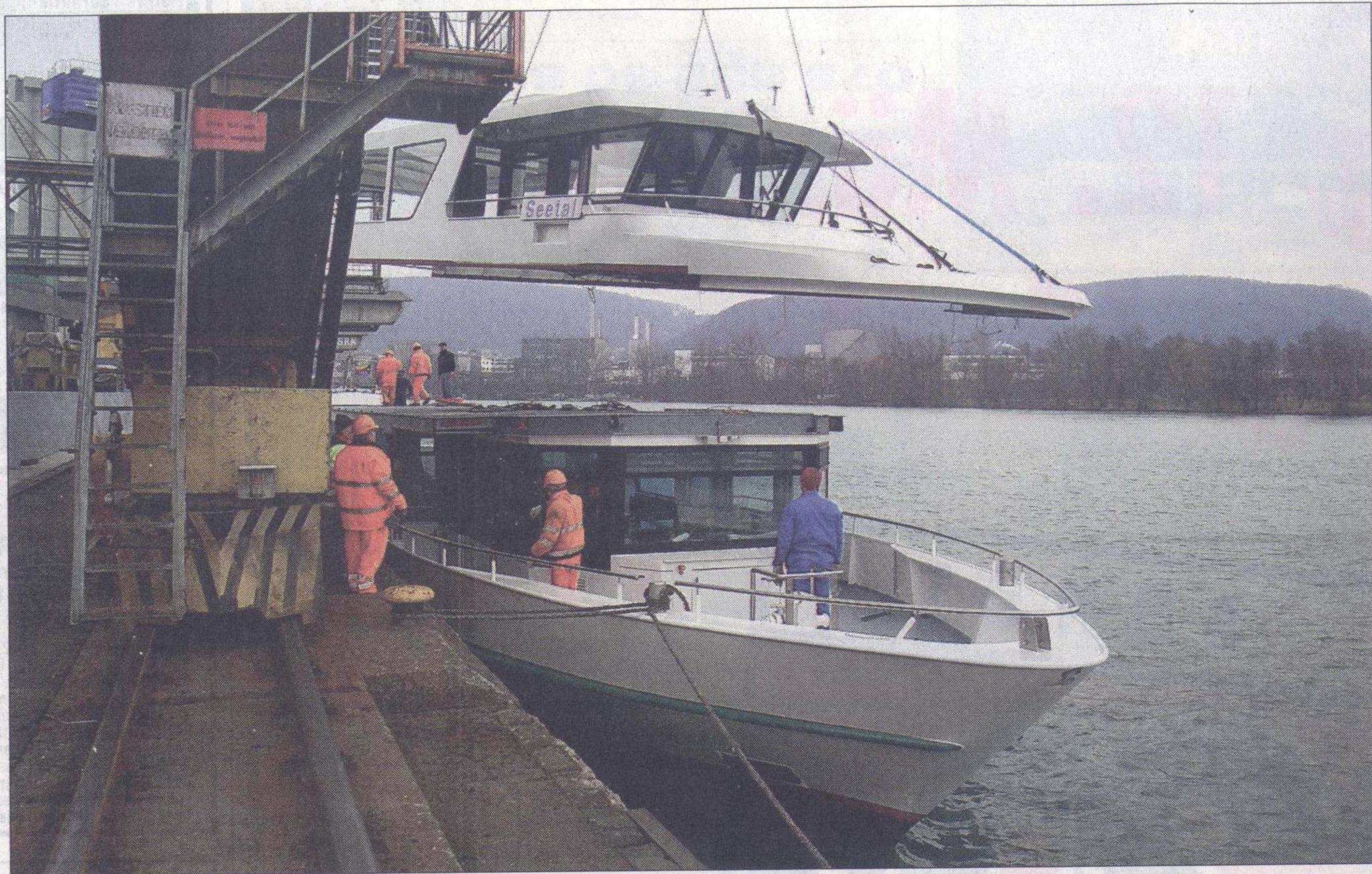
Die MS Seetal wird für den Weitertransport auf dem Landweg zwischen Ober- und Unterdeck getrennt.
